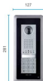
Thangram est la plaque vidéophonique semi-modulaire personnalisable autant pour les aspects fonctionnels que ceux esthétiques. La caméra avec optique grand-angle « wide eye » permet une ouverture 100° à l'horizontale et 82° à la verticale. Elle est dotée d'un zoom réglable et d'un illuminateur à 4 LED à haute efficacité avec intensité réglable.
