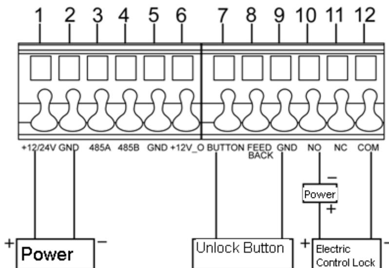
Wenn das Modul mit der elektrischen Schlosssteuerung verbunden wird, bedeutet dies, dass das positive Kabelende der elektrischen Schlosssteuerung an NO (Pin 10) und das negative Ende an COM (Pin 12) angeschlossen wird. Wenn das Modul mit der Entriegelungstaste verbunden wird, wird ein Kabelende der Entriegelungstaste an UNLOCK BUTTON des Moduls (Pin 7) und das andere Ende an GND (Pin 9) angeschlossen.
