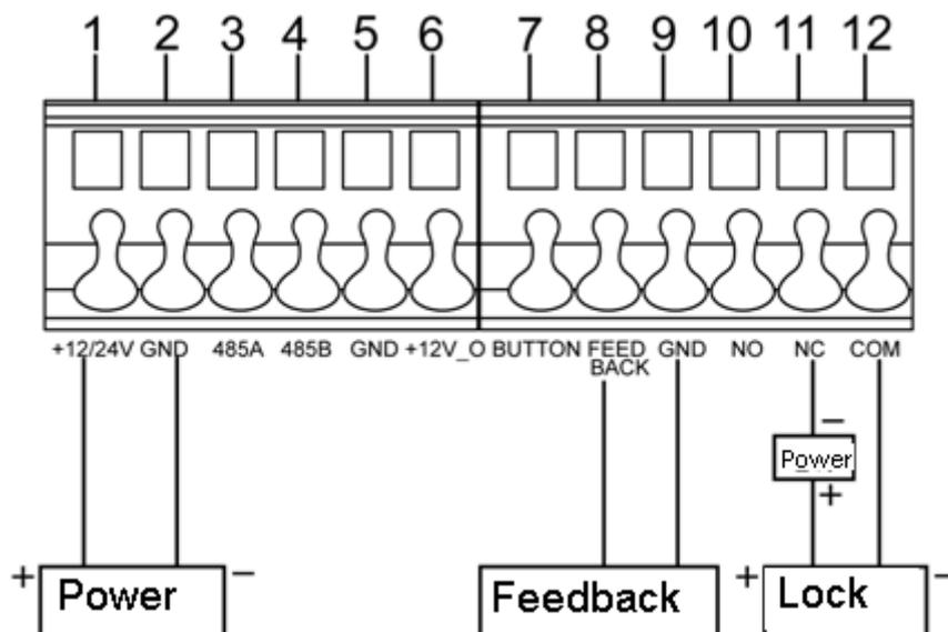
Wenn das Modul mit dem elektromagnetischen Schloss verbunden wird, bedeutet dies, dass das positive Kabelende des elektromagnetischen Schlosses an NC des Modul (Pin 11) und das negative Ende an COM (Pin 12) angeschlossen wird. Wenn das Modul mit dem Türsensor im elektromagnetischen Schloss verbunden wird, wird ein Kabelende des Türsensors an FEEDBACK (Pin 8) und das andere Ende an GND (Pin 9) angeschlossen.
